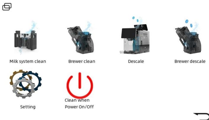
**Schritt 1:** Drücken Sie
